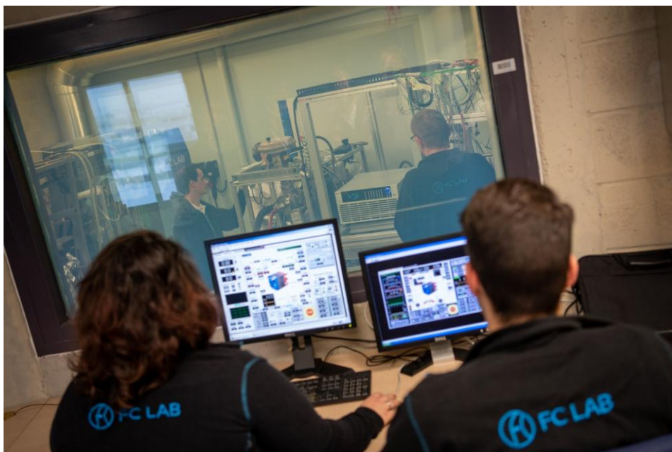
Figure 1 : pilotage d'un banc d'essai à distance depuis une salle dédiée
